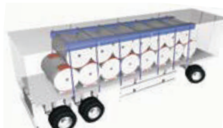
Leszorító hevederes rakományrögzítés csúszásgátló szőnyegekkel (piros) és élvédőkkel (kék).
