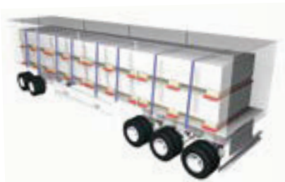
Leszorító hevederes rakományrögzítés csúszásgátló szőnyegekkel
